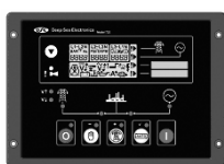
Рисунок 18.5 Контроллер DSE 720 с контролем нарушений в сети
